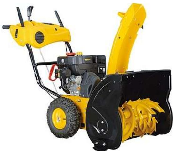
Снегоуборщик ST5706 оборудован четырехтактным одноцилиндровым бензиновым двигателем Zongshen ZS168FB с верхним расположением клапанов, объемом 196 см<sup>3</sup>.
