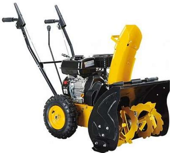
Снегоуборщик ST5605 оборудован четырехтактным одноцилиндровым бензиновым двигателем Zongshen ZS168FB с верхним расположением клапанов, объемом 196 см<sup>3</sup>.
