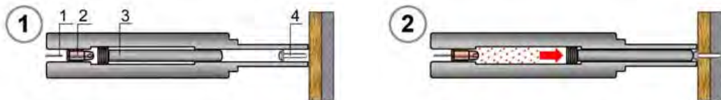
1. Боек. 2. Монтажный патрон. 3. Поршень. 4. Дюбель-гвоздь.
