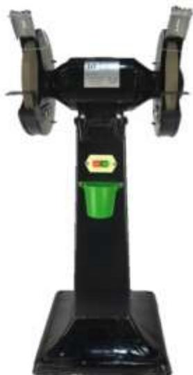
Станок точильно-шлифовальный двухсторонний используется для заточки станочного и ручного инструмента, обработки сборных и сварных конструкций (снятия фасок, заусенцев и т.п.), обработки изделий из порошковых материалов, металлокерамики и пр.
