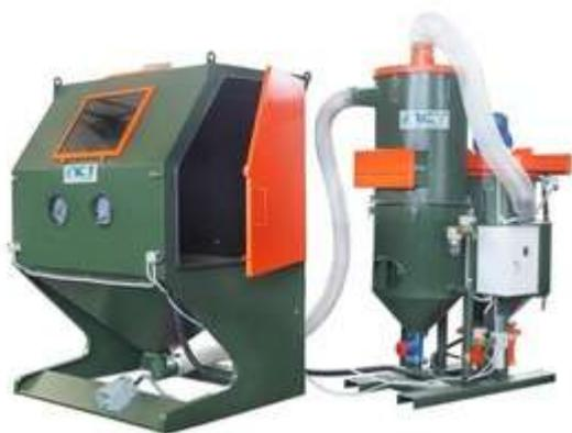
Абразивоструйная камера КСО-115-И-М используется заводами, промышленными цехами и различными мастерскими, которые не нуждаются в больших объемах работ. Представленная модель относится к камерам инжекторного типа, поэтому ее стоимость значительно ниже, чем цены на напорные модели.
