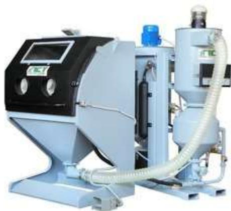
Абразивоструйная камера Российский КСО 8211 130-Н-ФВР-М 015-0019 применяется для подготовки поверхности перед нанесением антикоррозионных покрытий. Агрегат оснащен ножной педалью, которая позволяет оператору легко и без особых усилий совершать управление. Конструкция безопасна при эксплуатации, так как в зоне обработки находятся только КСО 130-Н-ФВР-М руки оператора, которые защищены надежным материалом. Модель проста в использовании и не требует дополнительного обслуживания.
