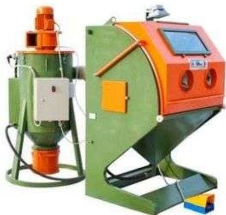
Абразивоструйная камера Российский КСО 211 130-И-ФВ-М 015-0018 - инжекторная, используется для очистки, снятия ржавчины и полирования. Для работы установки применяют сухой речной песок, КСО 130-И-ФВ-М сжатый воздух, металлическую дробь. Металлический корпус обеспечивает защиту всех внутренних узлов от механических повреждений.
