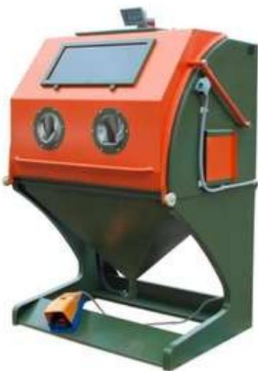
Камера абразивоструйная КСО-110-И-М используется для подготовки различных материалов к нанесению защитных, металлизационных и лакокрасочных покрытий.
