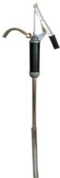
Насос бочковой ручной HG-1009 изготовлен из стали и предназначен для перекачивания жидкостей, таких как растительные, моторные масла (вязкость до SAE5), трансмиссионные масла (вязкость от SAE75W до SAE90), дизельное топливо, а также жидкостей устойчивых к материалам насоса. Насос имеет телескопическую трубу, опускаемую в бочку, что позволяет регулировать глубину погружения от 480 до 900 мм.
