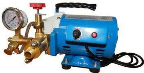
**Электропрессовщик DSY 3-60** позволяет определить герметичность трубопроводов, емкостей и инженерных систем. Аппарат может использоваться не только для проведения испытаний, но и для заполнения систем водой. Чешский производитель Zitrek позаботился о том, что бы каждая деталь инструмента была высокого качества. Достоинства представленной модели Аппарат имеет два обратных клапана. Простая и понятная конструкция не требует каких-либо особых знаний для работы с устройством.
