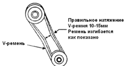
рис. 18 Натяжение V-ремня
