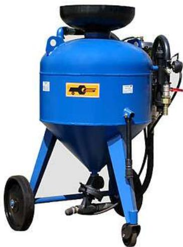
**Аппарат струйной очистки АСО-150** является аппаратом напорного типа для обработки и очистки воздушно-пескоструйным способом внутренних и наружных поверхностей от краски, окалина и коррозии, различного вида загрязнений, обезжиривания, а так же при подготовке поверхностей для окраски, при ремонтных работах и т.п. Для более эффективного результата необходимо использовать сопла Вентури.
