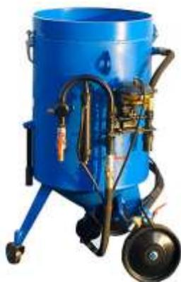
**Аппарат струйной очистки АСО-200** относится к аппаратам напорного типа для очистки воздушно-пескоструйным способом внутренних и наружных поверхностей от краски, окалины и коррозии, различного вида загрязнений и обезжиривания для нанесения краски, грунтовых смесей и т.д. К такому виду оборудования необходима соответствующая спецодежда: комплект защиты органов дыхания, специальные костюмы для пескоструйщиков, шлема, перчатки и пр.
