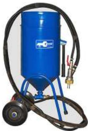
**Аппарат струйной очистки АСО-40Э** является аппаратом инжекторного типа для очистки воздушно-пескоструйным способом внутренних и наружных поверхностей от краски, окалина и коррозии, различного вида загрязнений, обезжиривания. Оптимально подходит для обработки средних площадей, благодаря низкой стоимости и сниженному потреблению сжатого воздуха.
